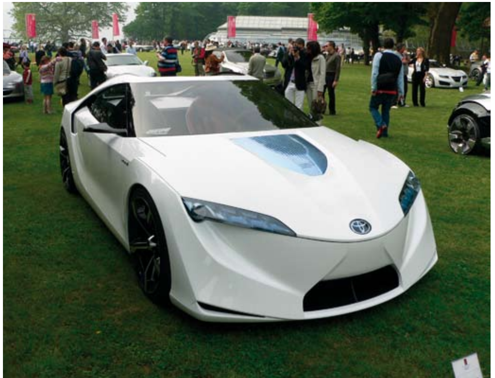
Toyota FT-HS, Sportwagen mit Doppelherz - 3,5-Liter-Benzinmotor und Elektromotor.
